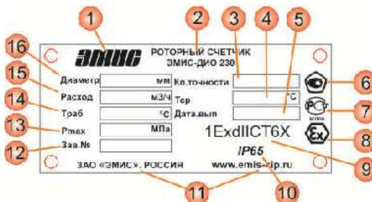
Рисунок 1.4 - Табличка счетчика
