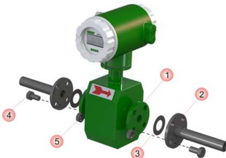
Рисунок 2.3 - Установка расходомера ЭМИС-МАГ 270 на трубопровод
