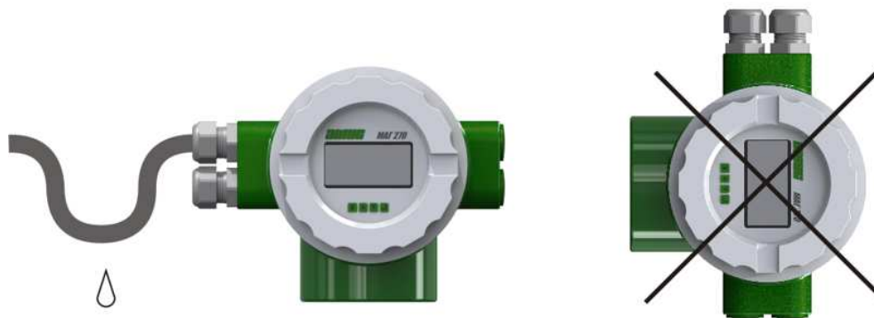
Рисунок 2.8 - Рекомендации по расположению кабелей и кабельных вводов
