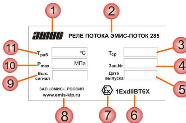
Рисунок 1.4 - Табличка реле потока
