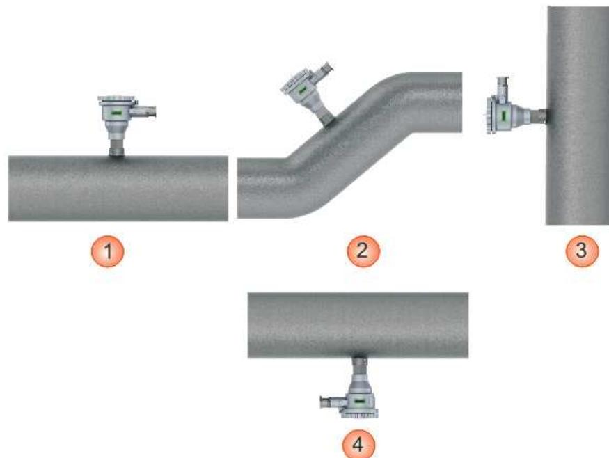
Рисунок 2.1 – Рекомендации по установке реле потока
