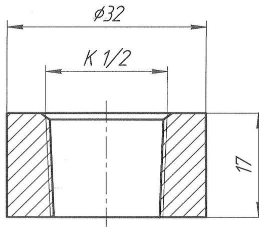
Рисунок А.2 - Габаритные и присоединительные размеры бобышки
