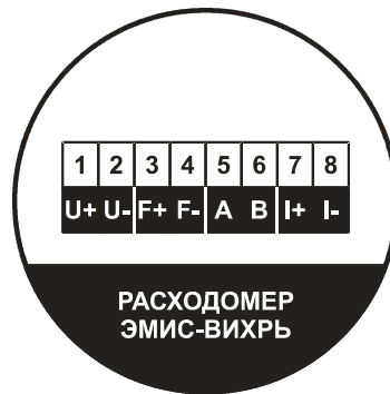
Рисунок Б.1 - Расположение зажимов клеммной колодки
