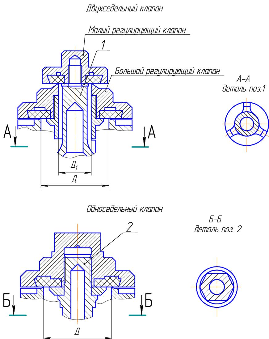
Рисунок 1 – Регулирующие клапаны исполнительного устройства
