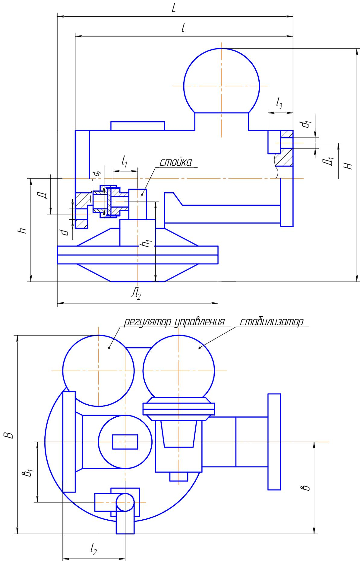
Рисунок 2 – Габаритные и присоединительные размеры регуляторов
