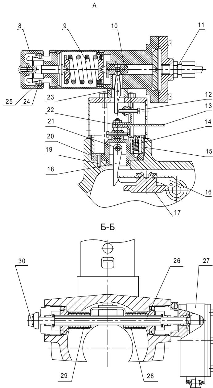
Рис.2 (продолжение) – Устройство защитное ЗУ 50М-04 000
